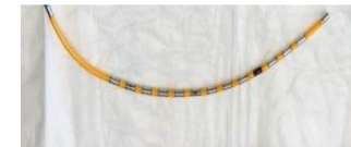
Catheter met digitale sensoren (OD 3.2mm) : 36 1cm-spaced druk sensoren
