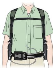
Dans le cas d'une veste-étui, le contrôleur se trouve dans une ceinture autour de votre taille et les batteries sont placées dans des poches prévues à cet effet, à raison d'une poche de chaque côté du corps.
